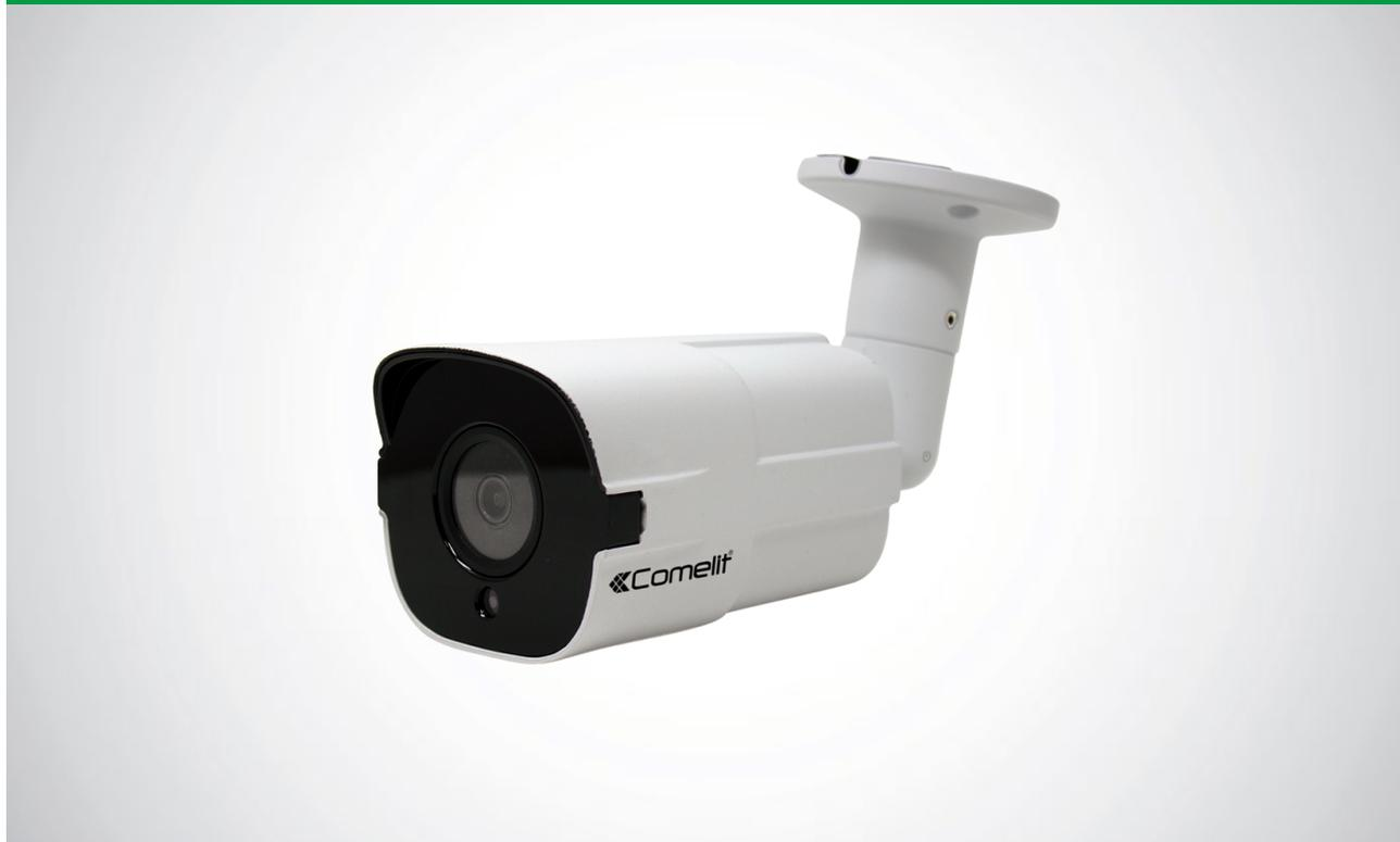
Telecamera IP all-in-one a colori Day & Night, ottica motorizzata varifocal da 2.8-12 mm con funzione autofocus, risoluzione 5MP@15 ips, contenitore waterproof IP66, 28 illuminatori ad infrarosso con portata di 25 metri, compatibile ONVIF 2.4.
