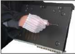
5. Fije los tornillos del disco duro.
