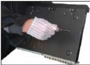
5. Fissare le viti del disco rigido.
