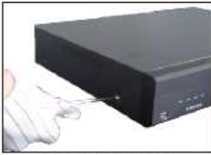
1. Extraiga los tornillos fijados de la cubierta superior del dispositivo.
