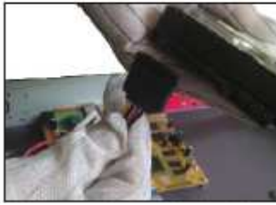
2. Conecte la línea de datos del disco duro.
