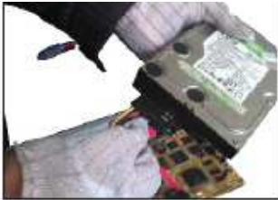
3. Brancher le câble d'alimentation du disque dur.
