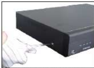
1. Smontare le viti di fissaggio della copertura superiore del dispositivo.
