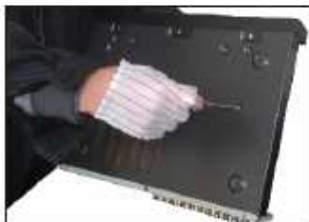
5. Fissare le viti del disco rigido.
