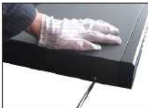
6. Fissare le viti della copertura superiore.
