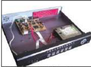
4. Ponga el disco duro en el lugar correspondiente de la máquina.
