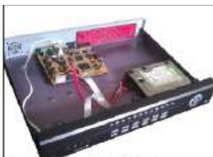
4. Collocare il disco rigido nella posizione corrispondente all'interno dell'apparecchio.
